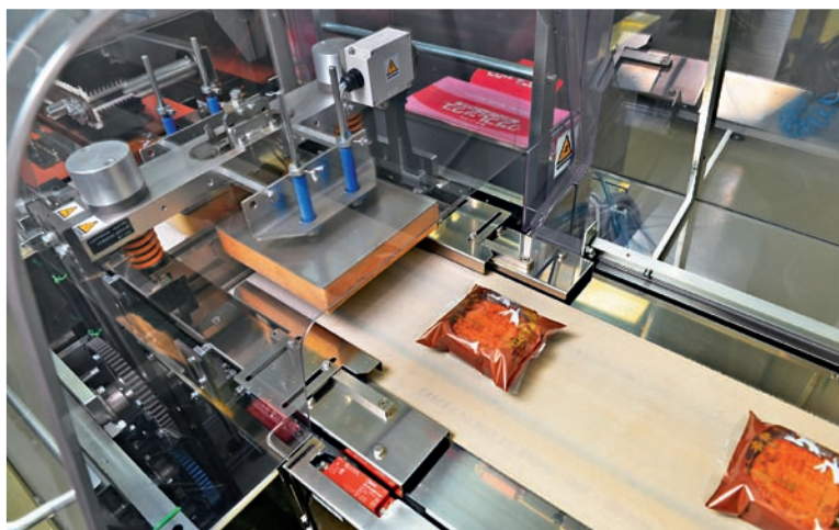
▲ 以月餅的包裝過程為例，其過程非常嚴謹，當中由金屬探測機、紫外綫殺菌機、吸氧劑探測機、試水儀等組成的生產流水綫，保證了產品的品質和效率。
