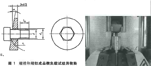
图 1 螺栓和螺钉成品楔负载试验用装置
