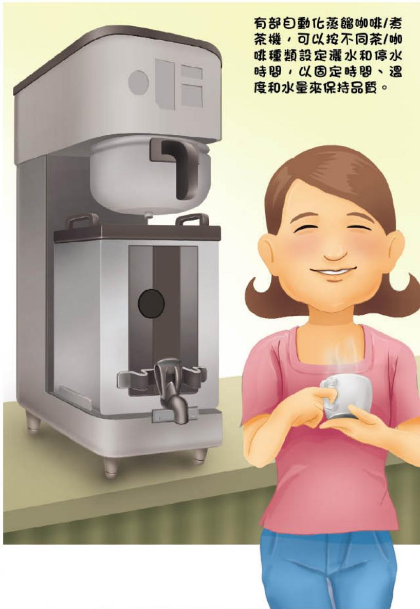
有部自動化蒸餾咖啡/煮茶機，可以按不同茶/咖啡種類設定灑水和停水時間，以固定時間、溫度和水量來保持品質。
