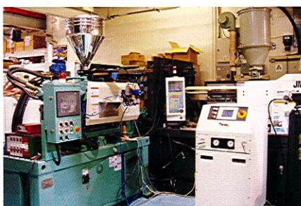
圖 3.8 一套完備的微發泡共注塑技術設備
