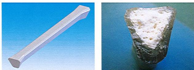
圖3.12 微發泡共注塑件 - 橫切面
