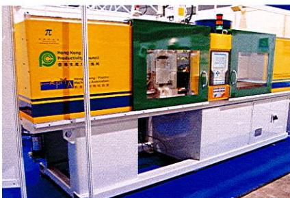
圖3.1 一套完備的全電動注塑技術設備
