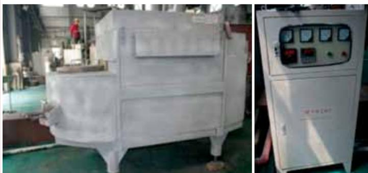
電中央鋁熔爐及控制箱
