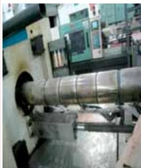
電磁感應加熱器炮筒設備
