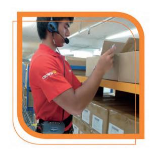
在揀選貨物的過程中,倉庫揀選員們可以 透過耳機設備用母語(粵語)接收語音指 令並作出回應,這樣能夠釋放員工的雙手 和雙眼,他們無須翻閱訂單表格或按手持 終端鍵盤或條碼閱讀器。因此,揀選員能 夠把精神集中在手中任務,使他們每日可 迅速流暢地揀選所接到訂單上的貨品,以 確保貨物能準時運送到不同零售地點。另 外,該語音系統可以保存指令,直到揀選 員走到貨架前讀出存儲位置的校驗碼,以 驗證要揀選的貨品位置是否正確。當揀選 員所回饋的校驗碼與後台系統針對該貨架 位的數據不相符合時,系統將告訴揀選員 「位置有誤」,從而避免揀選員提取了錯 誤的貨品。
