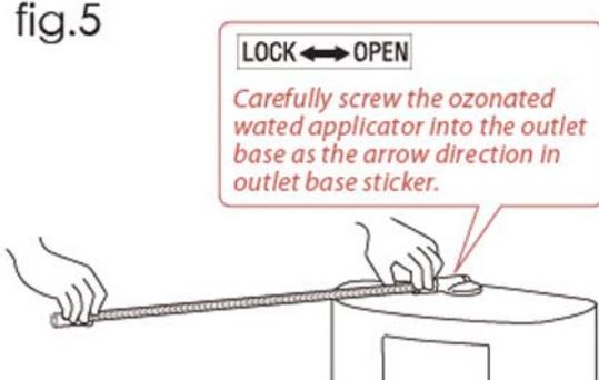
6. 於轉動出水口底座移除塑膠螺絲母帽，並將臭氧水噴灑喉連接至底座。妥善將臭氧水噴灑喉按圖5箭嘴方向擰緊。切勿胡亂安裝螺絲。
