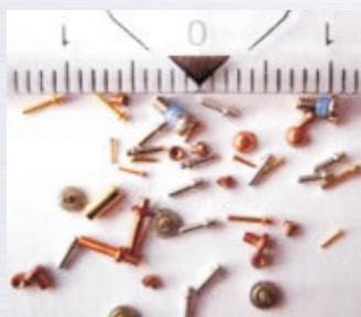
由微成型工藝製造 的微型金屬零部件
