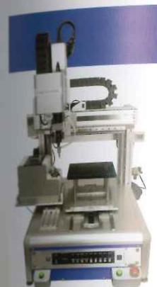
自動打螺絲機械系統
