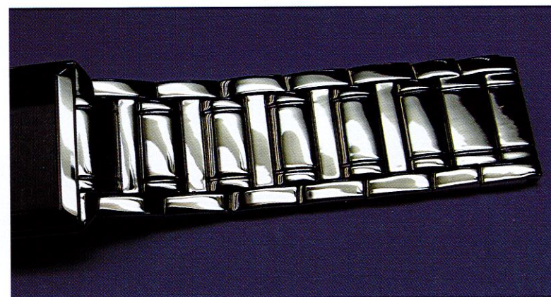
图 6.1 抛光后表面出现波浪纹 (由麦世枝先生提供)
