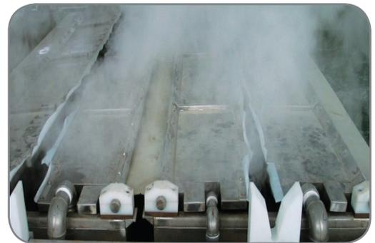
陽極氧化是一種使用電解工藝在鋁及其合金表面形成厚氧化層的過程，這層薄膜可以提升它們的耐腐蝕性和耐磨性。然而彩色陽極氧化層使用的有機染料在陽光影響下一段時間後會褪色，後繼的高溫表面處理也會使彩色陽極氧化層更脆弱、更容易發生熱應力開裂。對鎂合金來說，也需要一個額外的保護層以避免其磨損和腐蝕。隨著環保意識的提高，鋁合金和鎂合金已廣泛應用於綠色電子行業。其對提升鎂合金和鋁合金使用壽命的新的保護技術或功能塗層需求非常迫切。這種潛在技術使用較低的溫度和保護塗層可以提升這些金屬合金的耐腐蝕、防水、防退色、耐磨等性能。
