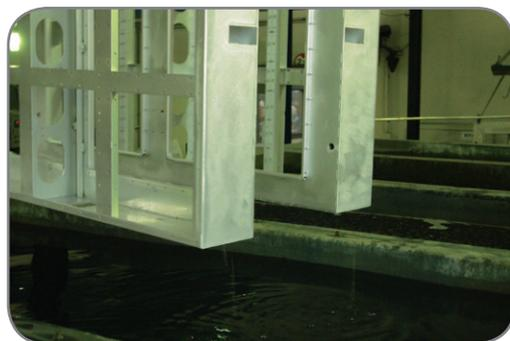
在家電行業中，油漆塗料是最常用的表面處理技術之一。預處理是高品質產品的關鍵一步。前處理工藝被廣泛用於提供金屬基材的耐腐蝕性，並增加對該產品在下一階段對油漆的附著力。磷化工藝被認為是最常用的塗裝前處理方法。儘管磷化是一種易於操作的常規方法，但存在許多相關的環境問題。首先，化學物會在電鍍槽底沉積的污泥，這些磷酸鹽和酸性廢物對環境是有害的。另外，隨著社會和政府對環境影響越來越大的壓力，家電行業已經被呼籲使用新的表面處理工藝，以取代傳統的磷化前處理工藝。納米塗層和矽基表面處理技術將是一些潛在的替代工藝。
