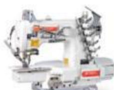
C007KD 气动式下摆车缝附左切刀修布边功能
