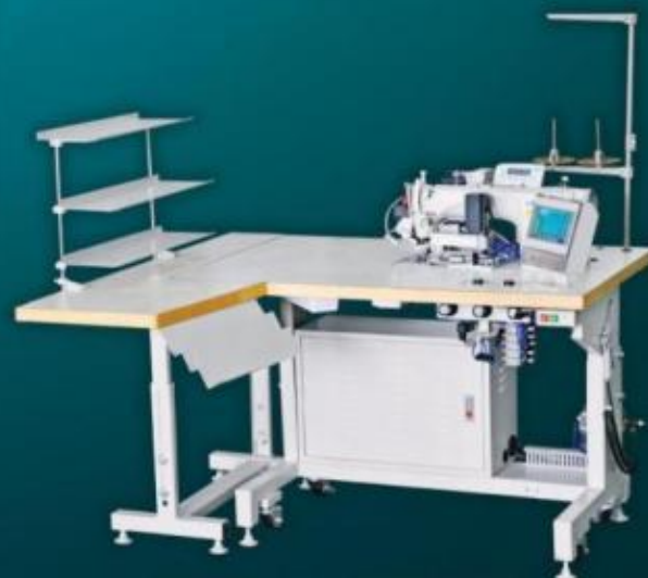
NS-6039-1 自動夾模縫紉機 Automatic Pattern Sewer
