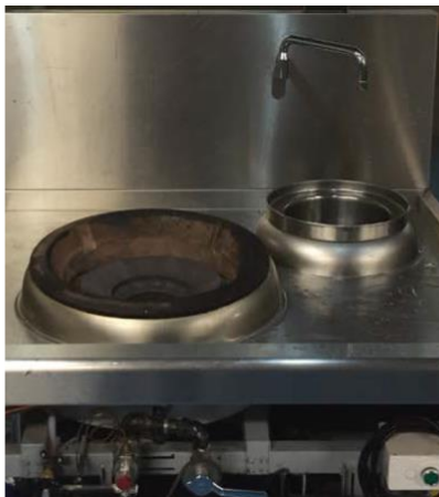
圖 4a) 深井設計可以保護燃燒器的火焰不被周圍的氣流沖散
