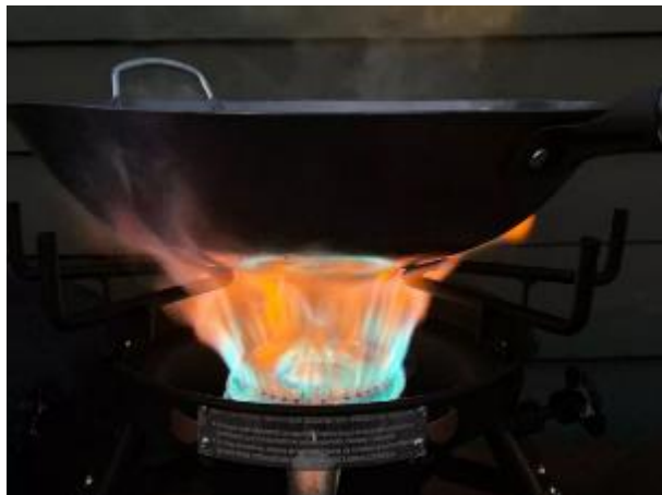
圖 4a) 深井設計可以保護燃燒器的火焰不被周圍的氣流沖散
