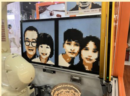
インスタントクリエーションのコンセプトを使用し、自動ロボットアームと組み合わせることで、積み木絵を瞬時に組み立てることができ、現代のテクノロジーと伝統的なおもちゃの魅力が一つに統合されていると言えます。自動ロボットアームは積み木を正確に操作し、さまざまなパターンや絵を素早く構築することができ、機械技術の正確さを実証するだけでなく、この伝統的なおもちゃに新しい遊び方や展示方法を与えます。
